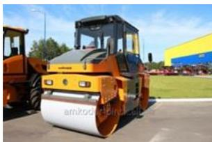
**Область применения:** предназначен для уплотнения асфальтобетонных покрытий и оснований различных типов, в том числе щебеночных, гравийных, шлаковых при строительстве и ремонте автомобильных дорог, аэродромов, промышленных площадок.
