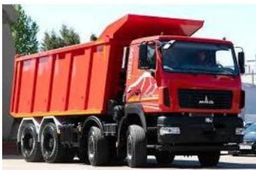
**Технические характеристики:** Четырехосный автомобиль-самосвал с повышенной грузоподъемностью. Технически допустимая общая масса 50 т., с колесной формулой 8x4, 8x8.
