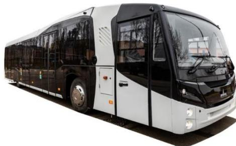
**Технические характеристики:** Двигатель Daimler OM 924 LA.V/1, Euro-5, мощностью 170 kW (238 h.p.), кондиционер.
