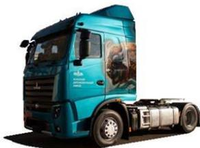
**Технические характеристики:** Технически допустимая общая масса 44 т., с колесной формулой 4х2 Двигатель Daimler (Euro-6), мощность 330 kW (476 h.p.).
