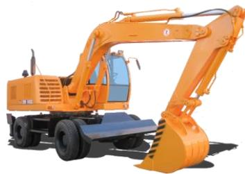
**Область применения:** предназначен для разработки котлованов, траншей, карьеров в грунтах 1-4 категории, погрузки и разгрузки сыпучих материалов, разрыхленных пород и мерзлых грунтов (величина кусков 200 мм max), для выполнения работ в промышленном, городском, сельском, транспортном и мелиоративном строительстве.
